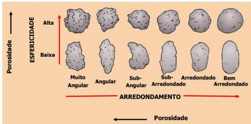
Figura 1: Relação entre arredondamento, esfericidade e porosidade.
