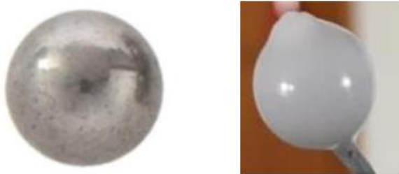
Figura 3: Esfera de aço carbono sem recobrimento e recoberta por um filme de Plastisol.
