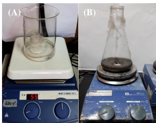
Figura 1: Precursores da síntese: (A) Gel de \text{TiO}_2 em banho maria a 55 \pm 5 \text{ }^\circ\text{C} e (B) Suspensão aquosa de pó de rocha basáltica.
