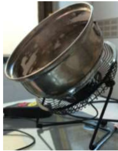
Figura 2: Configuração final do protótipo, com regulagem de inclinação e rotação.
