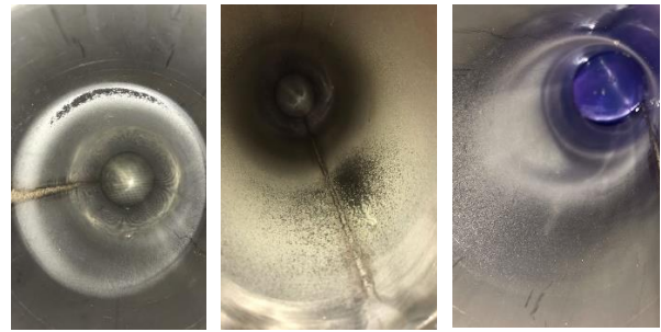
Figura 7: Imagem em diferentes posições do leito de frações mássicas retidas na parede.
