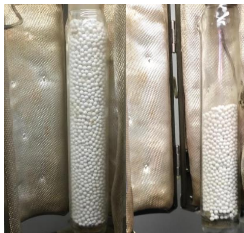
Figura 3: Reator de Leito Fixo R2 com: a) capacidade máxima; e b) metade da capacidade.
