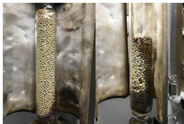
Figura 6: Reatores de Leito Fixo R2 após a pirólise.
