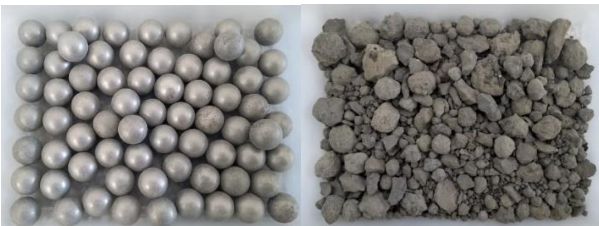
Figura 2: Amostra dos corpos moedores utilizados e de uma amostra de clínquer
