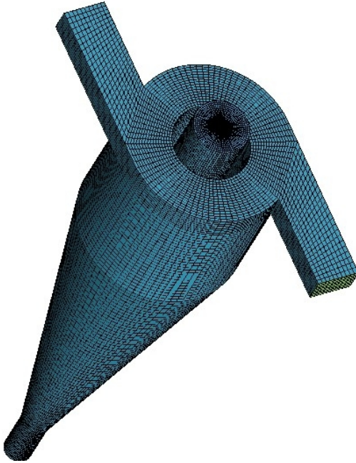
Figura 2: Malha computacional elaborada para simulação do hidrociclone de Hsieh (1988).
