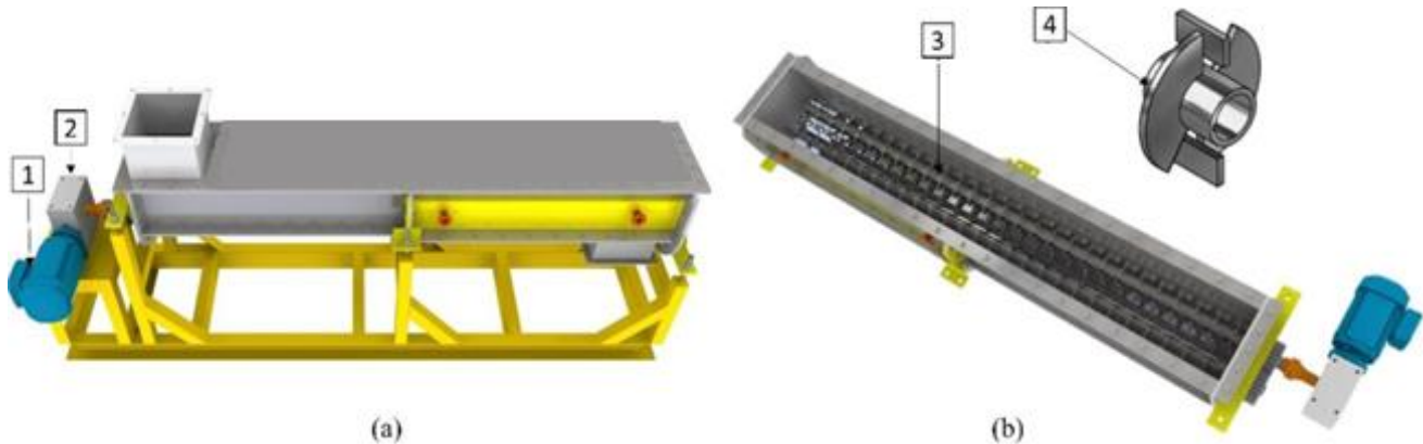
Figura 1: Paddle Dryer para (a) vista superior externa e (b) vista da estrutura interna.
