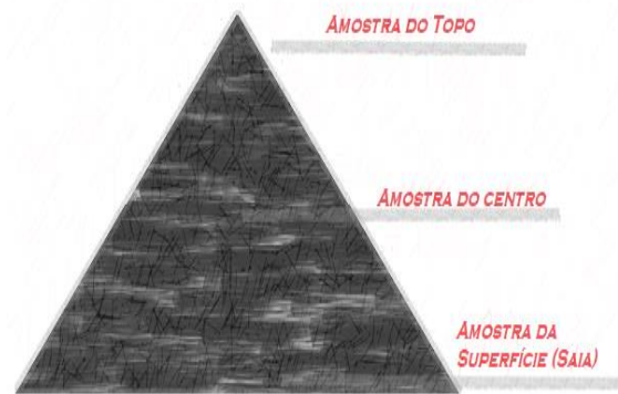
Figura 3: Esboço dos pontos de amostragem (topo, centro e superfície).
