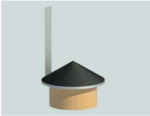
Figura 2: Aparato experimental para determinação de ângulo de repouso.
