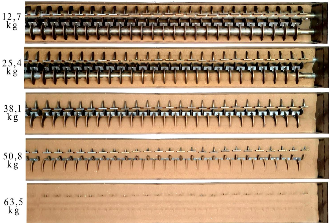
Figura 10: Fotos do leito do paddle dryer para as 5 variações de massa de areia estudadas.
