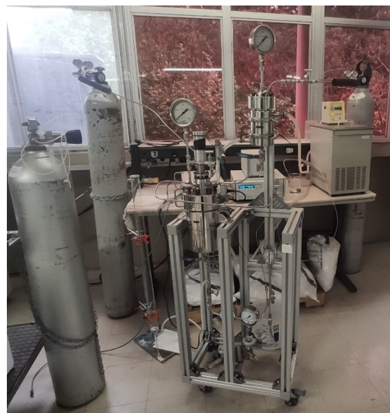
Figura 2: Sistema reacional a alta pressão utilizado nos experimentos.
