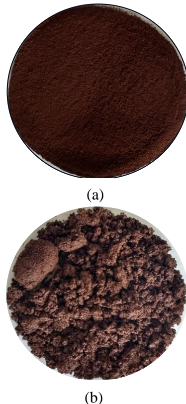
Figura 1: Finos de minério de ferro (a) seco e (b) com umidade de 10%.
