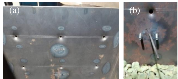
Figura 9: Parede posterior do secador: (a) furos de inserção do cabo de sustentação das seções da bandeja e (b) parafusos de proteção e termopar para leitura da temperatura do ar.
