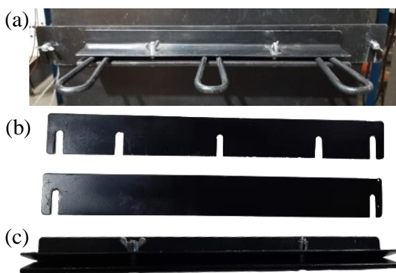
Figura 11: (a) Seções da bandeja fixadas e abertura vedada: (b) vedações para estágios com ou sem bandejas e (c) fixador de bandeja.
