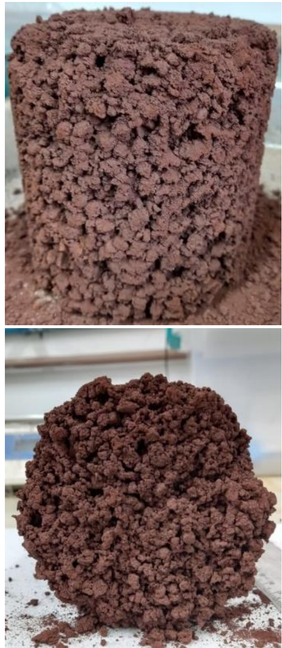
Figura 8: Fotografias do meio poroso de minério de ferro obtido após a secagem em camada espessa.
