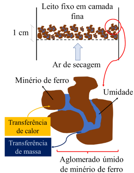
Figura 5: Ilustração esquemática dos aglomerados de minério de ferro úmidos e dos mecanismos de transferência presentes na secagem em leito fixo.
