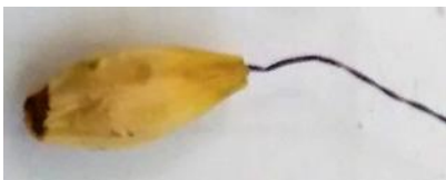
Figura 1 - Imagem de um grão de cevada com termopar implantado (Fonte: Acervo Pessoal, 2018).
