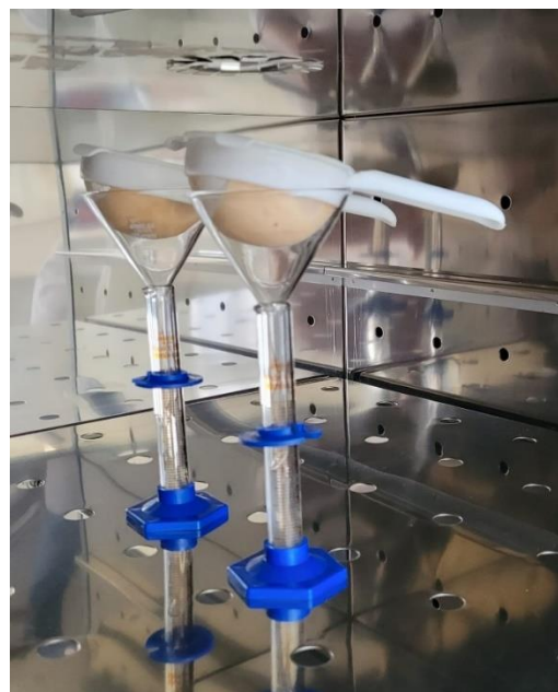
Figura 1: Ensaio experimental para a determinação da estabilidade das espumas.
