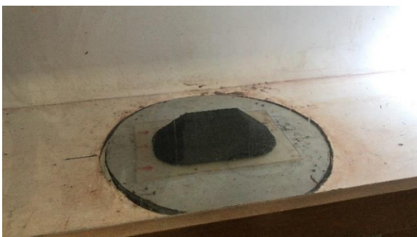
Figura 5: Disposição do modelo da pilha na seção de teste do túnel de vento.
