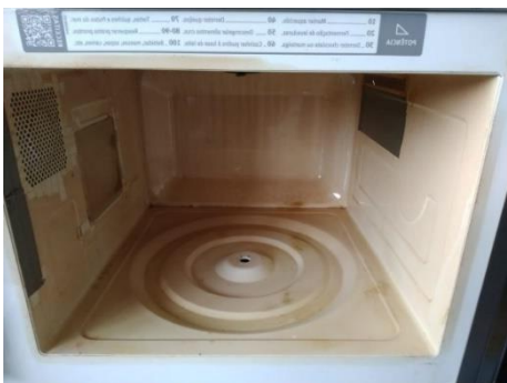
Figura 2: Cavidade multimodo do forno microondas.
