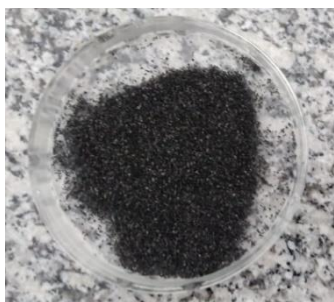
Figura 3: Amostra de carvão ativado utilizada no trabalho.
