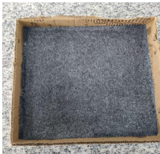
Figura 5: Solução de carvão ativado e cola branca depositada na placa.
