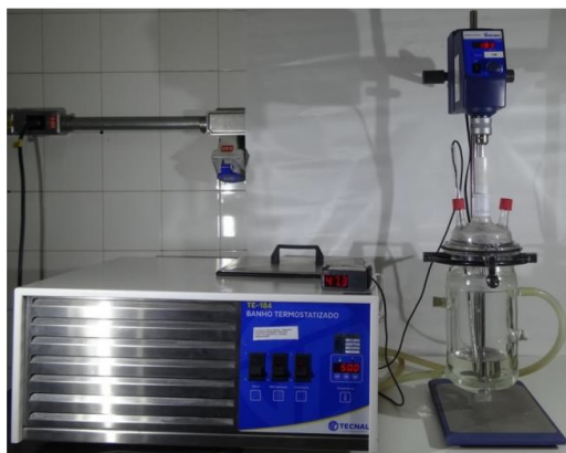
Figura 1: Unidade experimental de cristalização.
