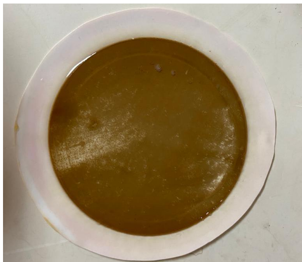
Figura 3 - Superfície da membrana de ultrafiltração após o processo da purificação de pectina.
