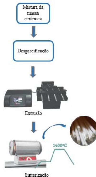
Figura 2: Esquema simplificado do processo de fabricação da fibra oca de alumina
