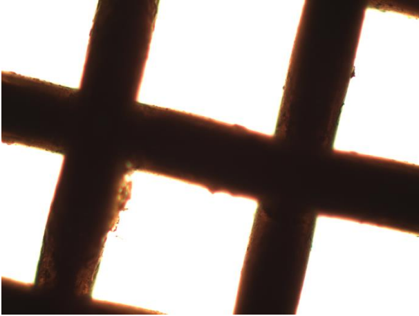
Figura 2: Tela de cobre (espessura: 0,23; abertura: 0,425 mm) utilizada como substrato para deposição das fibras. Ampliação de 5x.
