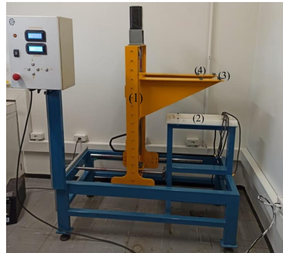
Figura 2: Estrutura metálica e sistema fonte-detector de raios gama. (1) Parte móvel. (2) Base de apoio para o cilindro. (3) Posição da fonte. (4) Posição do detector.
