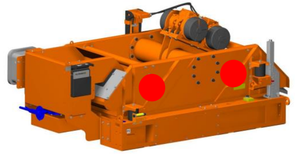
Figura 6: Regiões de fixação do sensor na estrutura do equipamento.
