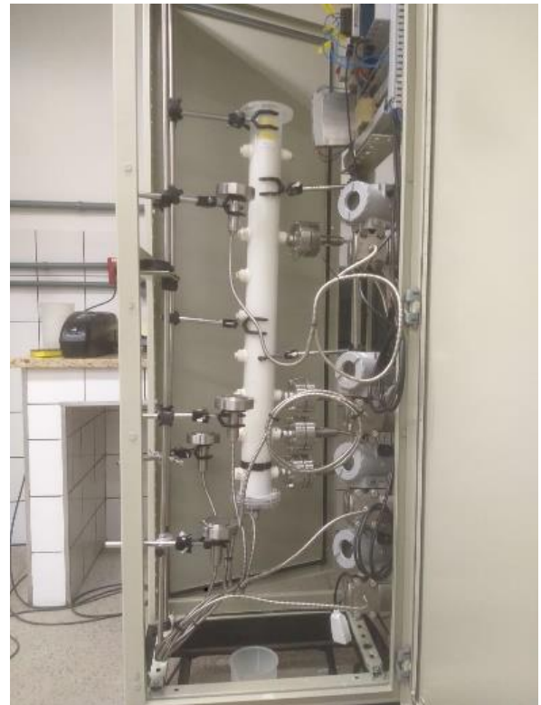
Figura 3: Imagem da unidade experimental de bancada de monitoramento dos sólidos.
